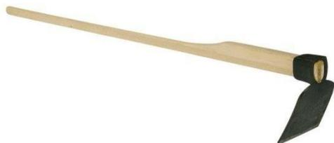
Мотыга - ручное орудие для рыхления (в собирательстве и земледелии) или копания почвы, рабочая часть которого поставлена под углом к рукояти, как правило, деревянной.
