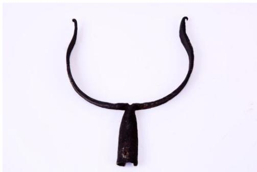
**Ухва́т**, или рогáч, — приспособление, представляющее собой длинную деревянную палку с металлической рогаткой на конце. **Ухватом** захватывали и ставили в русскую печь глиняные горшки и чугуны. Под каждый размер чугуна был свой **ухват**.
